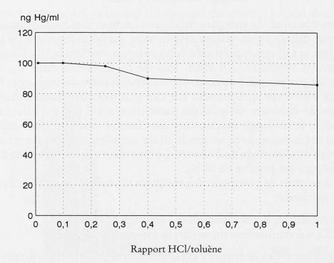
Fig. 3. Effet du rapport de volume acide chlorhydrique/toluène à partir d'une solution standard de chlorure de méthyle mercure (100 ng/ml de Hg) dans acide chlorhydrique fumant/eau 1:1.
