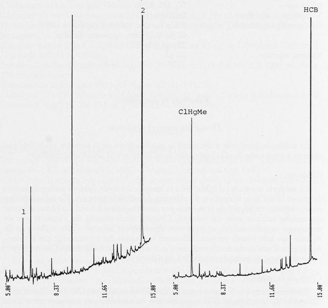
Chromatogramme d'un échantillon Fig. 1. positif (0,35  $\mu$ g/kg). chromatographiques (Conditions voir partie expérimentale) Pic 1 = chlorure de méthyle mercure Pic 2 = hexachlorobenzène (standard interne)
