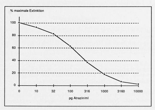
Abb. 6. Standardkurve eines normalen Atrazin-EIA
