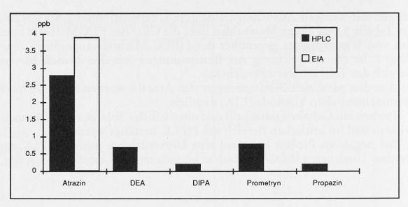
Abb. 8. Messwerte einer Wasserprobe mit erhöhtem Triazingehalt. Höherer EIA-Wert infolge Kreuzreaktion mit weiteren Triazinen
