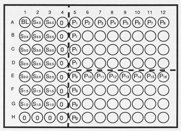
Abb. 5. Lokalisation und Anordnung der Proben (P) und Standards (S) auf MTP
