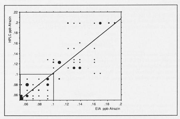
Abb. 7. Atrazinbestimmung in Grundwasser mit EIA und HPLC, vergleichende Darstellung von 84 Messwerten im Bereich des Toleranzwerts (0,1 ppb). Grosse Punkte bedeuten mehrere Bestimmungen mit gleichen Ergebnissen
