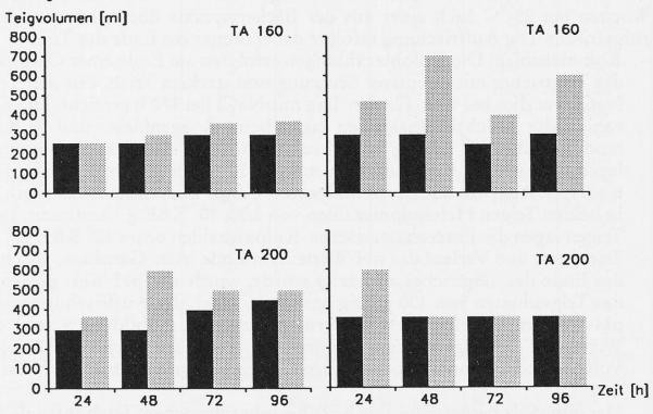
Abb. 4. Ruchmehl- und Weissmehl-Spontansauerteige mit Teigausbeuten von 160 und 200: Teigvolumen im Ausgangsteig und nach Gärzeiten von 24 h bei 22 °C und 35 °C jeweils zu Beginn und am Ende der Gärphasen (TA = Teigausbeuten)
