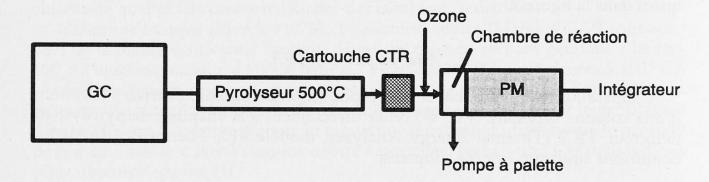
Fig. 1. Principe de détection des nitrosamines par le détecteur spécifique TEA
