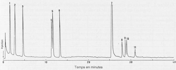
Fig. 3. Séparation et détection par TEA d'un mélange étalon de VNA et TSNA (0,5 ng par pic)
