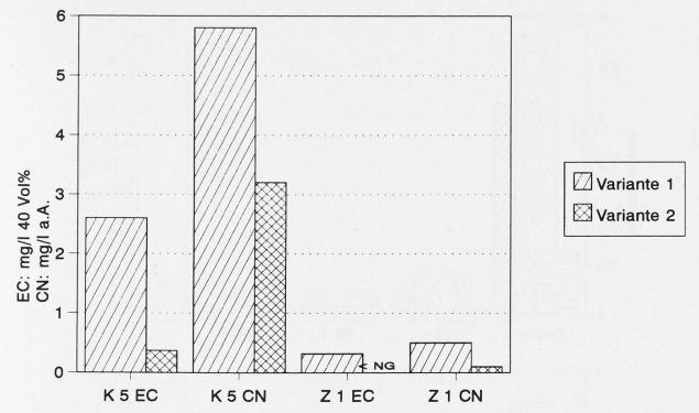
Abb. 2. Einfluss der Anordnung der Katalysatoren auf die Gehalte an Urethan und Cyanid in den Destillaten (vgl. Abb. 1). Für die Beschreibung der Maischen siehe Tabelle 1
