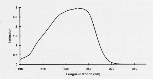
Fig. 2. Spectre d'absorption dans l'UV du 7-cétocholestérol
