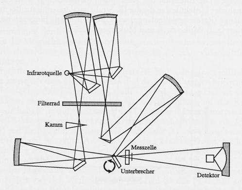
Abb. 2. Optisches System des Milko-Scan-Gerätes (6)
