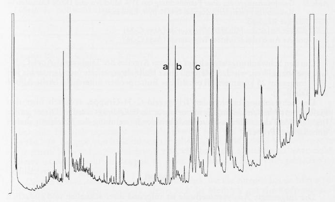
Abb. 2. Gaschromatogramm einer Fettmischung mit 14,4% Milchfettanteil in Kakaobutter (Standard-Zugabe: 0,46% bzw. Einwaage)
