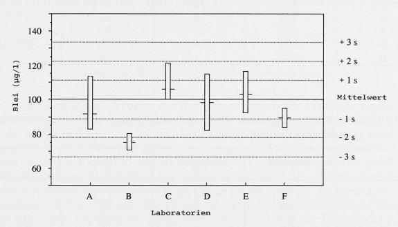
Abb. 2. Qualitätskontrolle: Resultate der einzelnen Laboratorien für Blei in der Kontrollprobe
