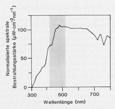
Abb. 5. Emissionsspektrum des Sonnenlichtes (nach 57)
