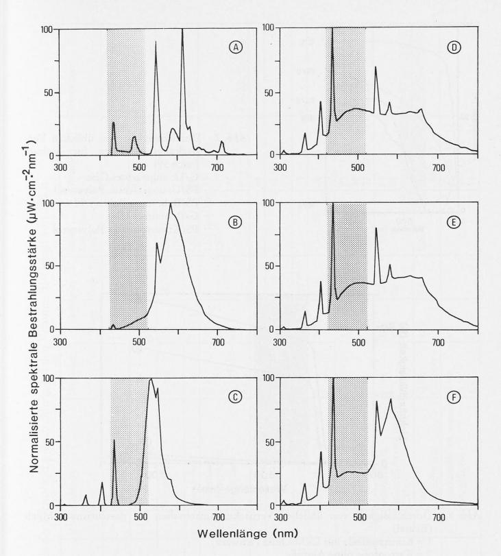
Abb. 6. Emissionsspektren einiger kommerzieller Fluoreszenzröhren (nach 58)
