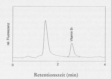
Abb. 1. RP-HPLC-Bestimmung des Vitamins B<sub>1</sub> in Milch als Thiochrom unter Verwendung eines Fluoreszenzdetektors
