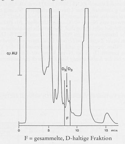
Abb. 2. Präparatives Chromatogramm des Etherextraktes von verseifter Margarine (4)
