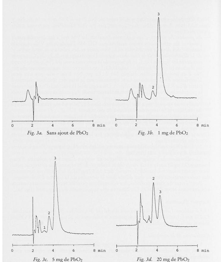
Fig. 3. 4 chromatogrammes d'un échantillon positif (40 µg/kg). Oxydation de la leucobase en fonction de la concentration du PbO<sub>2</sub>, temps de réaction: 30 secondes (Conditions chromatographiques: voir partie expérimentale)
