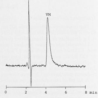
Fig. 2a. Chromatogramme d'une solution standard d'oxalate du vert de malachite (25 pg/µl). Conditions chromatographiques: voir partie expérimentale
