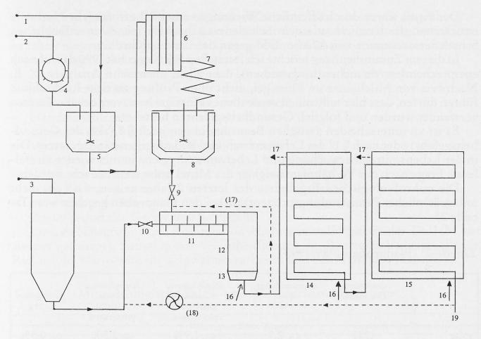
Abb. 1. Schema einer Eierteigwarenfabrikation
