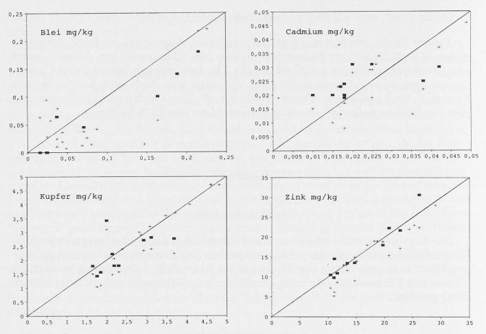
Abb. 1. Übereinstimmung der Vergleichsanalysen zwischen dem Labor 1 (x-Achse) und den Kontrollaboratorien 2 (■) und 3 (+) (y-Achse)
