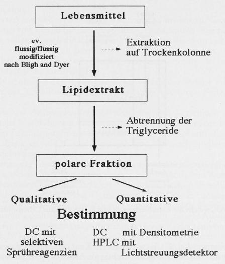
Abb. 4. Schema zur Emulgatoranalyse
