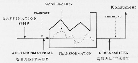
Abb. 1. Bereiche der Qualitätssicherung bei der Herstellung von Lebensmitteln, in denen Fettanalysen benötigt werden
