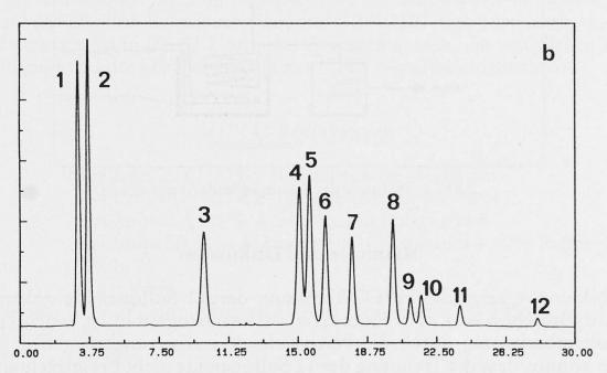
Abb. 4. Chromatogramm einer Standardlösung mit je 0,1 mg/l der einzelnen Sulfonamide a = UV-Detektion, b = Fluoreszenzdetektion
