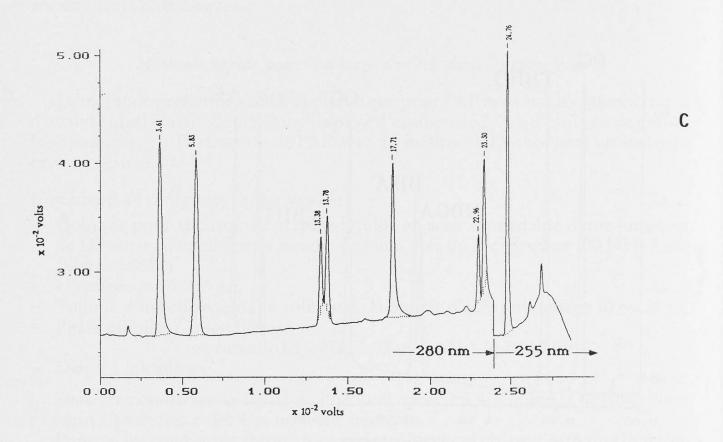
Fig. 1. Chromatogramme du standard des 8 antioxydants selon la méthode générale mesuré à différentes longueurs d'ondes
