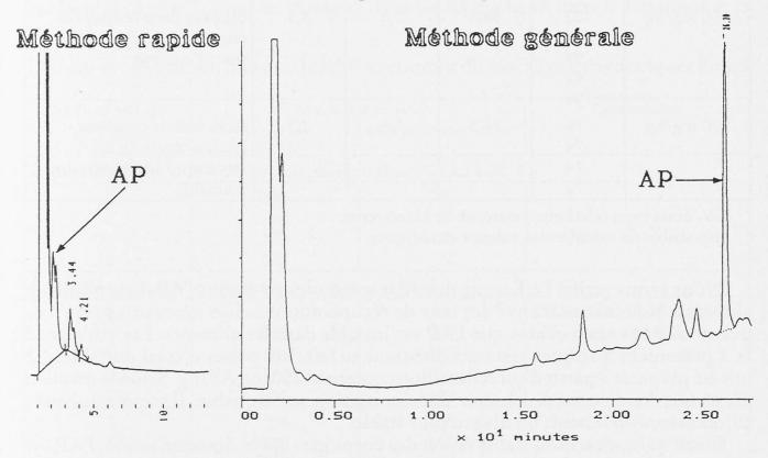
Fig. 2. Chromatogrammes d'une farine lactée et d'un bouillon de légumes dopés avec de l'AP. Dosage de l'AP selon la méthode rapide pour les corps gras et la méthode générale pour les denrées alimentaires. Conditions décrites dans le texte
