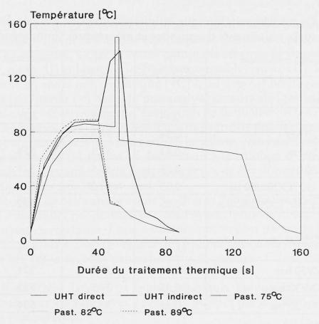
Fig. 1. Diagramme température/durée des traitements thermiques appliqués
