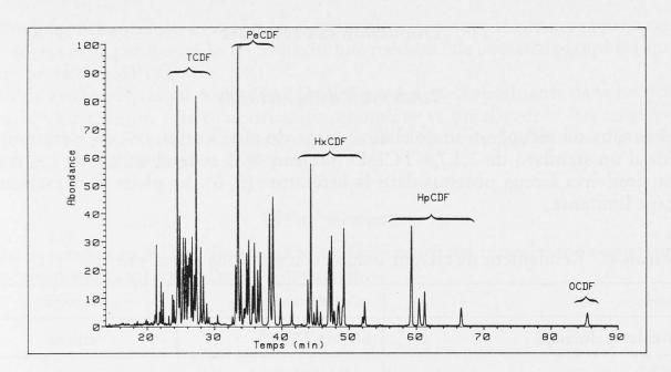
Fig. 4. Chromatogramme des PCDF dans les poussières d'électrofiltre
