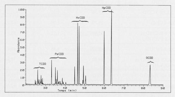
Fig. 3. Chromatogramme des PCDD dans les poussières d'électrofiltre
