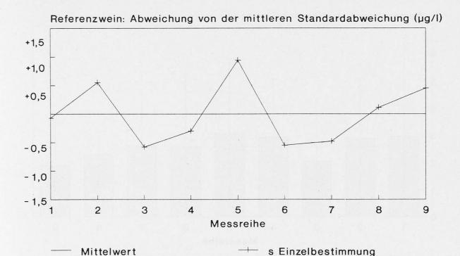
Abb. 4. Wiederholte Analyse des Referenzweines: Die mittlere Standardabweichung (s) der jeweils 3 oder 4 Einzelmessungen war praktisch identisch mit derjenigen bei der Analyse des Kunstweines
