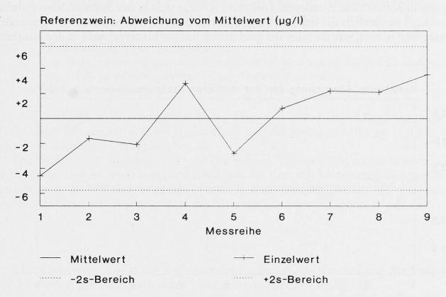
Abb. 3. Wiederholte Analyse des Referenzweines: Der Gehalt keiner Referenzwein-Kontrollprobe lag ausserhalb eines Grenzbereiches von ± 2 Standardabweichungen (s) um den mittleren Gehalt
