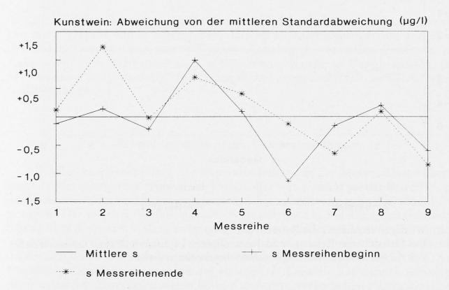
Abb. 2. Wiederholte Analyse des Kunstweines: In der mittleren Standardabweichung (s) von 1,3 μg/l kommen vor allem Geräteschwankungen und Pipettierungenauigkeiten zum Ausdruck
