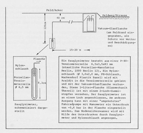
Abb. 3. Schema einer im Projekt Klettgau verwendeten Lysimeteranlage
