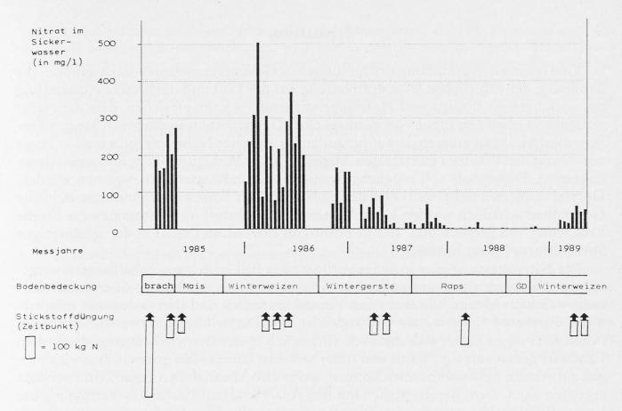
Abb. 6. Verlauf der Nitratauswaschung bei einem viehlosen Betrieb auf einem schweren Boden
