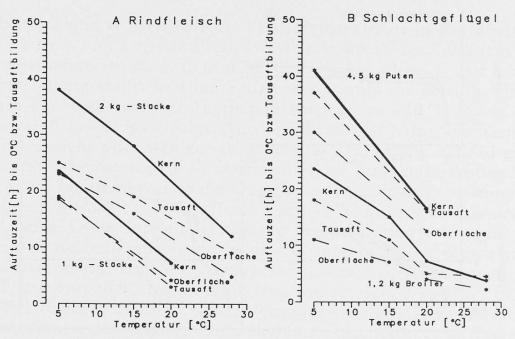
Abb. 2. Auftauzeiten in Stunden, nach denen bei tiefgefrorenen Probestücken nach Auftauen bei 5, 15, 20 und 28 °C an der Oberfläche und im Kern 0 °C erreicht wurde, sowie Beginn der Tausaftbildung (Mittelwerte mehrfacher Versuchsserien)
