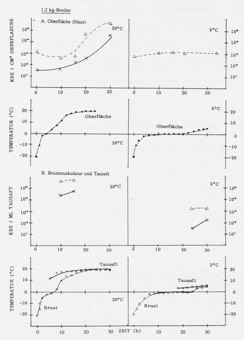
Abb. 5. 1,2-kg-Broiler, Temperaturverlauf, Gesamt- und Pseudomonaden-Koloniezahlen während des Auftauens der tiefgefrorenen Probestücke bei 5 und 20 °C A. in der Haut
