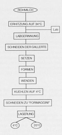
Abb. 1. Fliessdiagramm der standardisierten Formaggini-Herstellung aus Rohmilch unter Laboratoriumsbedingungen
