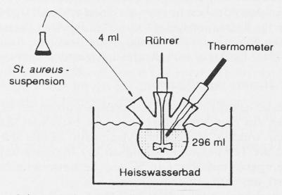
Abb. 2. Schematische Darstellung der Versuchsanordnung zur Bestimmung der Hitzeinaktivierung von 6 S. aureus-Stämmen
