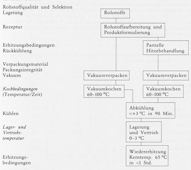
Abb. 1. Der Sous-Vide-Prozess (schematisch)
