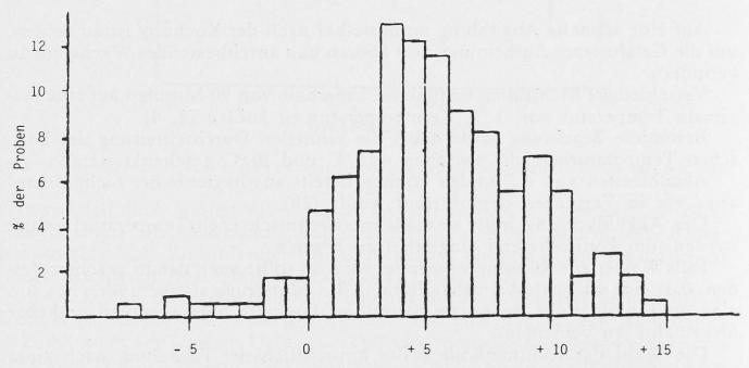
Abb. 4. Temperaturverteilung von Fleischpackungen in Kühltheken des Einzelhandels (299 Produkte) (22)
