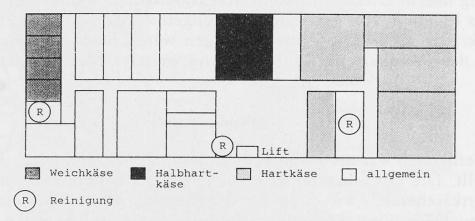
Abb. 4. Zoneneinteilung und Reinigungsmöglichkeiten nach der Sanierung
