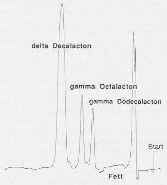
Abb. 2. Flüssigchromatogramm von Standards zur Festlegung des Fensters der  $\gamma$ -Lactone. Triglyceride (Fett) und  $\delta$ -Lactone müssen von den  $\gamma$ -Lactonen abgetrennt werden, was durch die Verwendung von acetonitrilgesättigtem n-Pentan erreicht wurde
