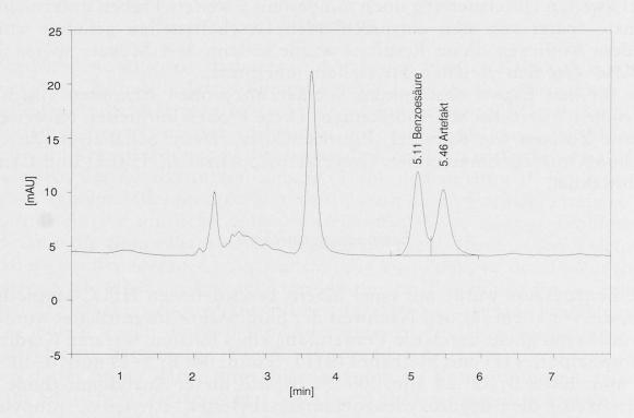
Abb. 1. Chromatographische Auftrennung der Benzoesäure in Käse
