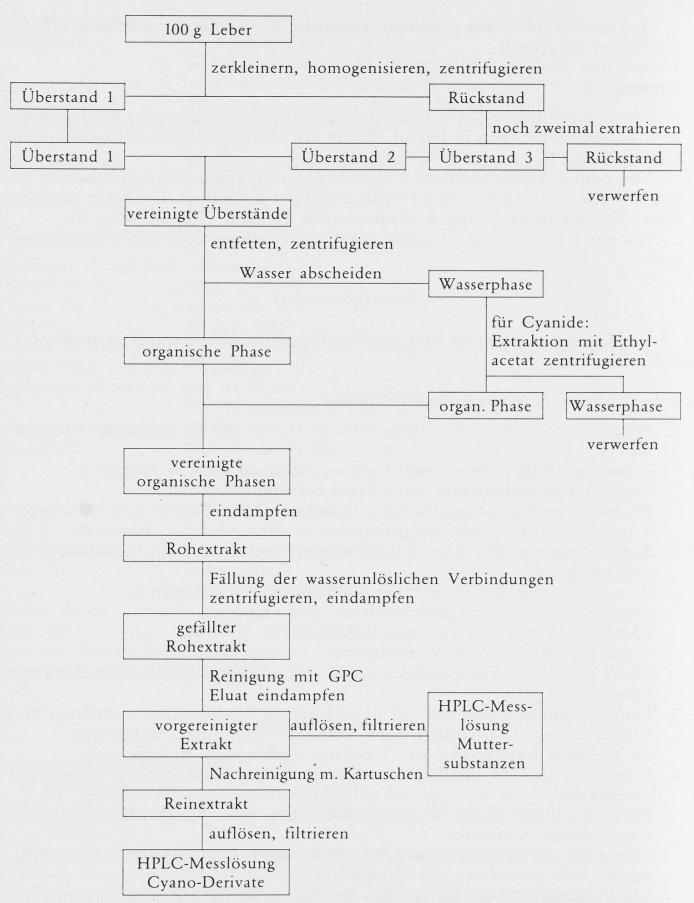
Abb. 2. Flussdiagramm der Extraktionsmethoden
