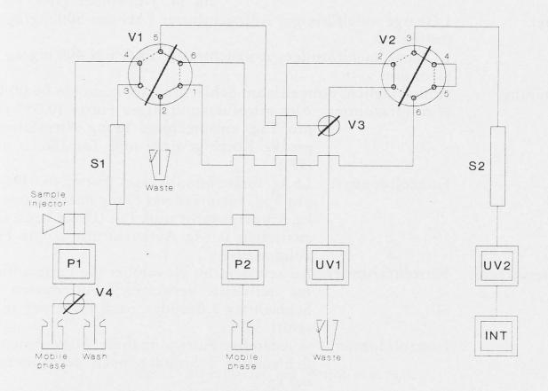
Abb. 3. Säulenschaltung mit zwei Ventilen
