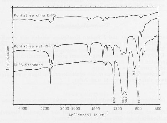
Abb. 4. IR-Spektren von DMPS in Konfitüre
