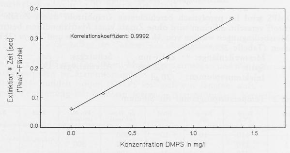
Abb. 3. Bezugskurve DMPS in Isooctan, Graphitofen-AAS
