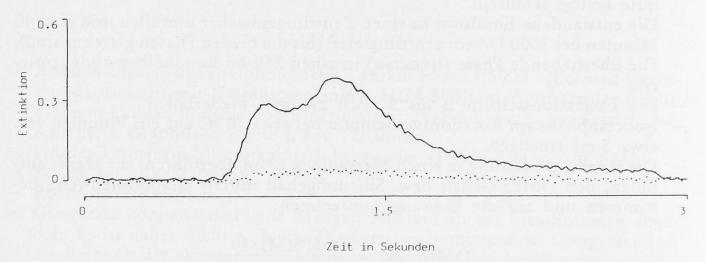
Abb. 2. Spezifische und unspezifische Absorption bei der Atomisierung einer Bezugslösung mit einem DMPS-Gehalt von 1,6 mg/l (Siliciumgehalt  $\sim$  0,6 mg/l)
