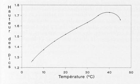
Fig. 3. Effet de la température (°C) sur la hauteur des pics (unité arbitraire) Concentration en éthanol de la solution injectée: 10 μg·ml<sup>-1</sup> Débit du flux porteur: 1 ml·min<sup>-1</sup>
