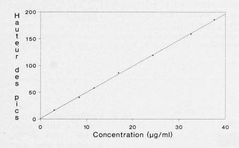
Fig. 5. Droite d'étalonnage effectuée avec des dilutions d'échantillons de sang. Ces dilutions (100 fois) ont des concentrations en éthanol comprise entre 3–40 μg·ml
