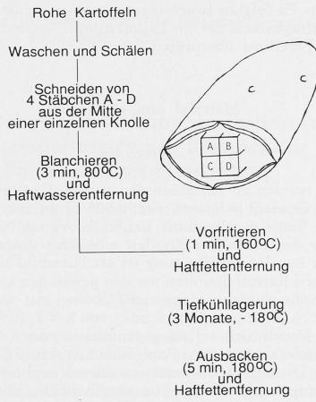
Abb. 1. Schema der Pommes-frites-Herstellung im Labormassstab und Lage der für die Versuche aus einzelnen Kartoffelknollen herausgeschnittenen Stäbchen
