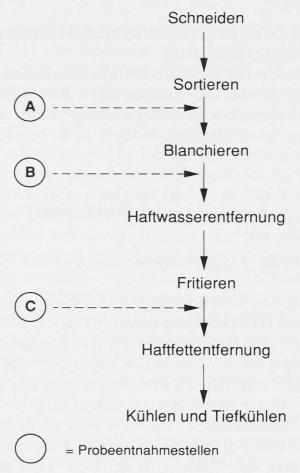
Abb. 2. Schema der Herstellung von vorfritierten, gekühlten oder tiefgekühlten Pommes frites im Industriemassstab (ohne Wasch- und Schälschritt) und Probenahmestellen in der Produktionslinie
