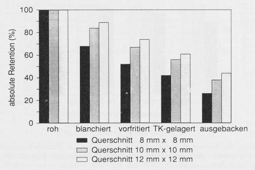
Abb. 5. Einfluss der einzelnen Verarbeitungsschritte und des Stäbchenquerschnittes auf die summierte absolute Ascorbinsäureretention bei der Pommes-frites-Herstellung im Labormassstab
