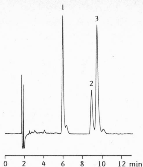
Fig. 3. Séparation par chromatographie HPLC d'un mélange de lycopène (1, 0,9 \mu\text{g/ml} ), \alpha -carotène (2, 0,4 \mu\text{g/ml} ) et \beta -carotène (3, 1 \mu\text{g/ml} ). Eluant: acétonitrile-dichlorométhane-éthanol 70:20:10 (v/v/v), débit 1,5 ml/min. Autres conditions chromatographiques: voir partie expérimentale
