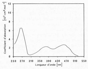
Fig. 6. Spectre d'absorption de la vitamine B<sub>2</sub> (riboflavine)
