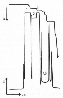
Abb. 3. Isotachopherogramm von 1 Riboflavin-5-Natriumphosphate, 2 Nicotinsäure, 3 Folsäure, 4,5 Biotin und Pantothensäure. (Entnommen aus: «Analytical and Preparative Isotachophoresis», 112—113 [1984]. Verlag Walter de Gruyter u. Co., Berlin.)
