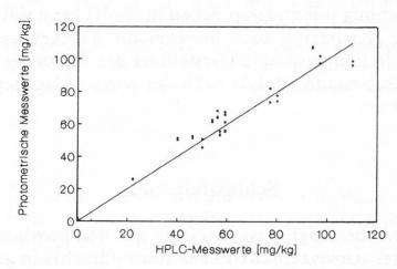
Abb. 3. Vergleich der vorgeschlagenen HPLC-Methode mit einer photometrischen Methode für die Sorbinsäurebestimmung unter Berücksichtigung von eventuellen Artefakten
