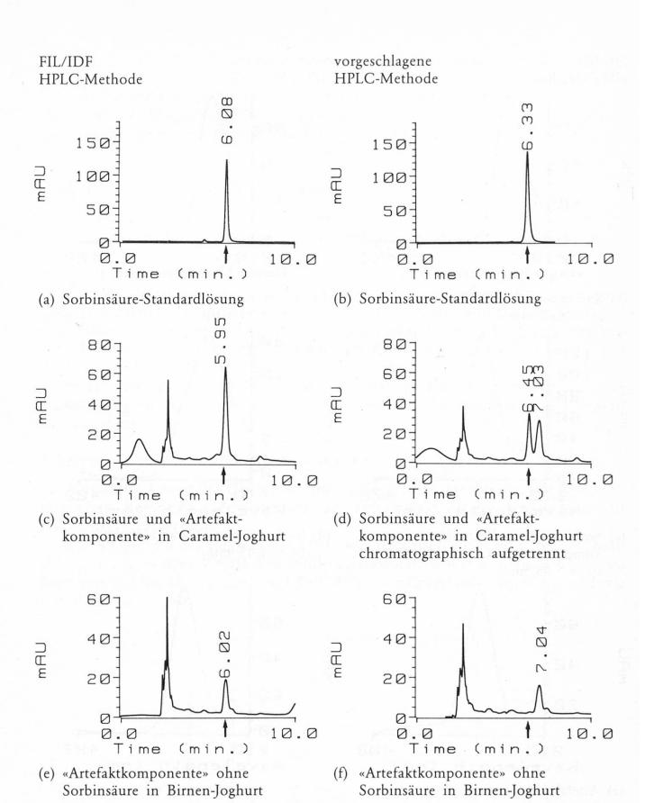
Abb. 1. Sorbinsäurebestimmung mittels HPLC bei 254 nm unter Berücksichtigung von Artefakten
