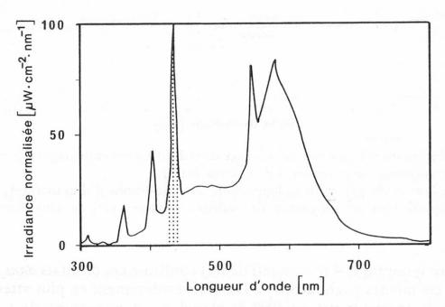
Fig. 1. Spectre d'émission des tubes fluorescents utilisés (TL Philips 33/40 W) Le pic hachuré correspond à la raie d'émission (à 436 nm) de la vapeur de mercure du tube, malencontreusement situé au voisinage du maximum de la bande d'absorption de la riboflavine (444 nm).
