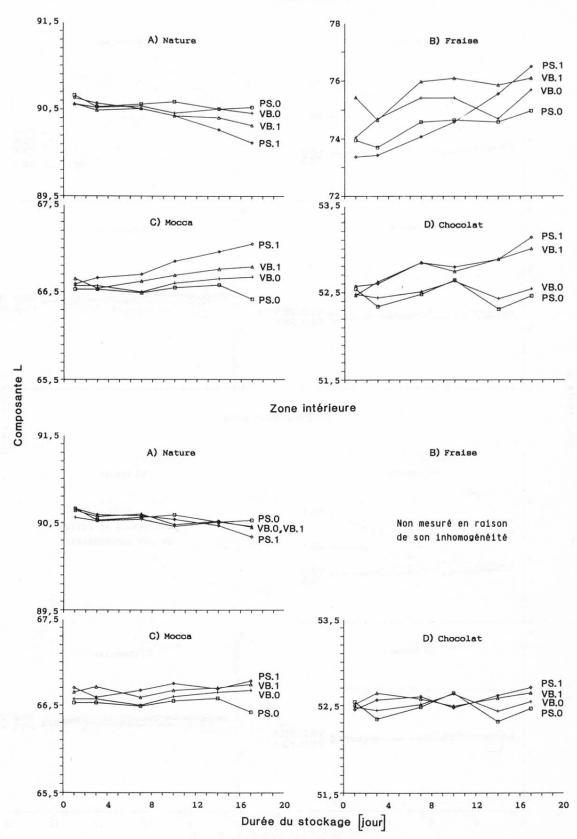
Fig. 4. Evolution de la composante L (brillance ou luminance) des yoghourts nature, fraise, mocca et chocolat dans diverses conditions de stockage (21 jours sous 0 et 2000 lux) 0 < L < 100
