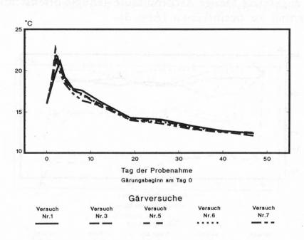
Abb. 1. Temperaturverlauf in Zwetschgenmaischen
