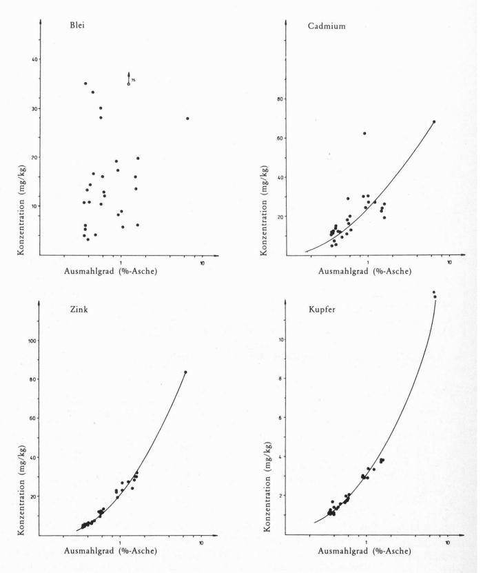
Abb. 5. Abhängigkeit der Metallgehalte vom Ausmahlungsgrad
