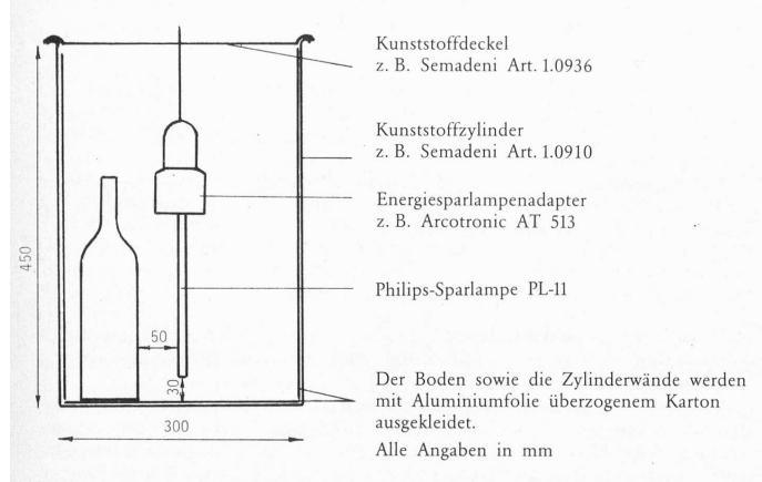
Abb. 2. Belichtungsbox für die beschleunigte Ethylcarbamatbildung
