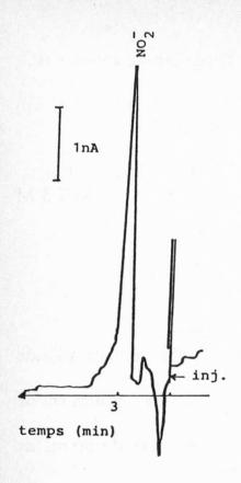
Fig. 1. Chromatogramme de 6,44 μg/l de nitrite; potentiel: + 1,1 V/Ag/AgCl/KCl 3 M
