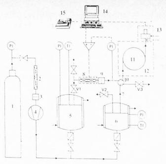
Abb. 1. Apparatur zur direkten Kopplung Fluidextraktion-Kapillarfluidchromatographie
