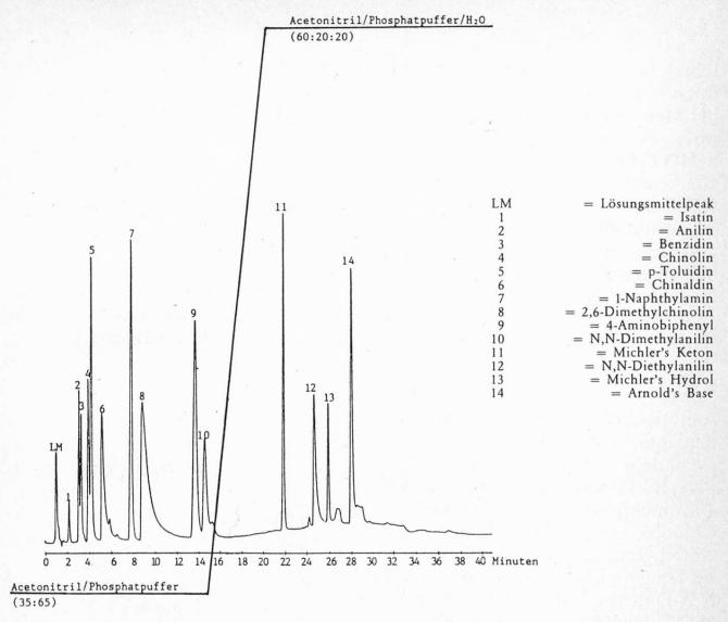
Abb. 1. HPLC-Chromatogramm von organischen Verunreinigungen in synthetischen Lebensmittelfarbstoffen
