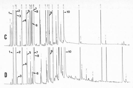
Fig. 2. Tracciati HRGC-HS (C) ed HRGC (D) dell'estratto ottenuto per HPE con CO<sub>2</sub> supercritica (300 atm/35 °C/60 min) da Rosmarinus officinalis
