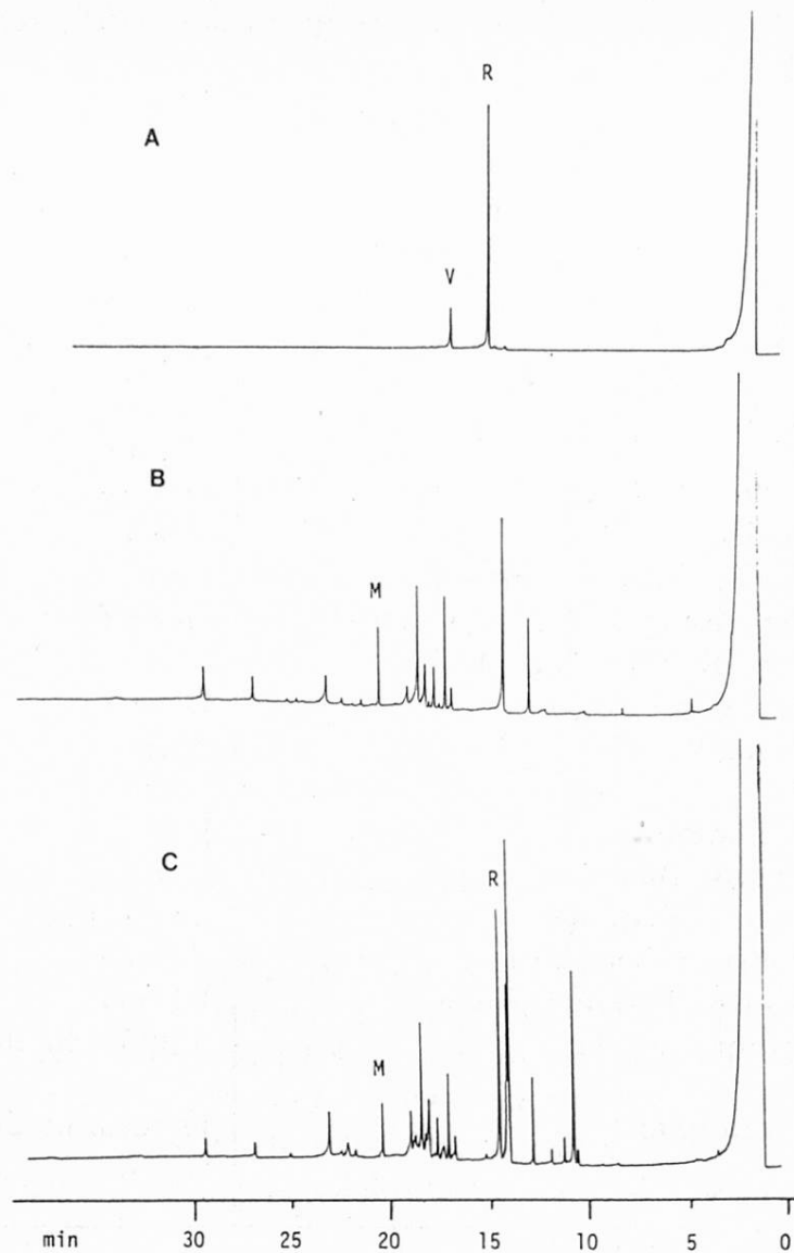
Abb. 1. Gaschromatogramme, Bedingungen siehe Text A = Rishitinstandard; R = 10 ng; V = unbekannte Verunreinigung B = Extrakt einer gesunden Kartoffel; M = interner Standard Methylarachidat C = Extrakt einer mit Phytophthora infizierten Kartoffel. Der Rishitingehalt wurde zu 55 mg/kg berechnet
