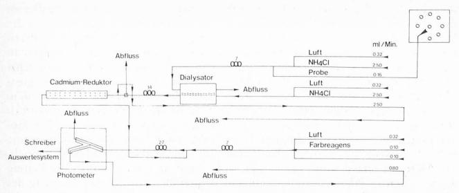
Schema der Apparatur für segmentierte Fliessinjektionsanalyse
