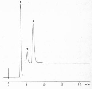
Fig. 3. Chromatographie HPLC de l'extrait obtenu à partir d'un vernis à ongles (selon la méthode (5)), contenant C.I. 15850 (1), C.I. 15880 (2) et C.I. 15865 (3). Conditions chromatographiques identiques à celles de la figure 1
