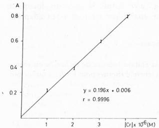
Fig. 2. Droite d'étalonnage de solutions de CrCl<sub>3</sub> dans HCl  $10^{-2}$ M (cuve: 4 cm, temps d'ébullition: 15 min, 0,5 ml de Na<sub>2</sub>S<sub>2</sub>O<sub>8</sub> 0,1M, réactif: diphénylcarbazide,  $\lambda = 546$  nm)
