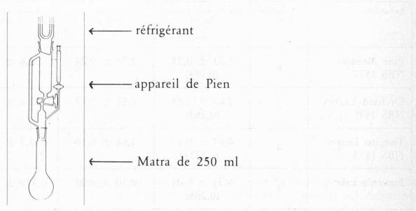
Fig. 1. Appareillage pour la décomposition de matières végétales. L'ensemble est chauffé par un bec Bunsen
