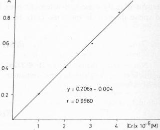
Fig. 3. Droite d'étalonnage de solutions de  $(NH_4)_2CrO_4$  dans  $H_2SO_4$  0,5·10·3M (réactif: diphénylcarbazide,  $\lambda = 546$  nm)
