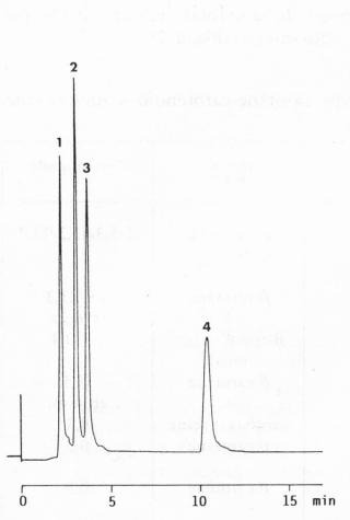
Fig. 1. Séparation par chromatographie HPLC en phase inversée et régime isocratique d'un mélange de canthaxanthine (1),  $\beta$ -apo-8' caroténal (2), ester éthylique de l'acide  $\beta$ -apo-8' caroténique (3) et  $\beta$ -carotène (4). Conditions chromatographiques: voir partie expérimentale
