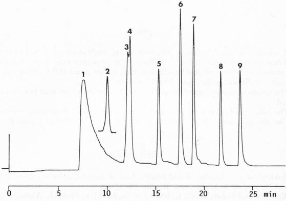
Fig. 3. Séparation par chromatographie HPLC, avec gradient d'élution binaire, de la bixine (1), capsantéine (2), zéaxanthine (3), lutéine (4), canthaxanthine (5),  $\beta$ -apo-8' caroténal (6), ester éthylique de l'acide  $\beta$ -apo-8' caroténique (7), lycopène (8) et  $\beta$ -carotène (9).
