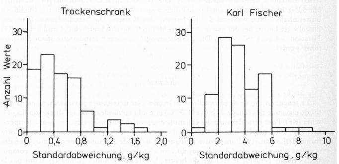
Abb. 2. Häufigkeitsverteilung der Standardabweichungen für die Wasserbestimmung von Butter nach der Trockenschrank- und KF-Methode. Die Abszissen haben unter schiedliche Skalen!
